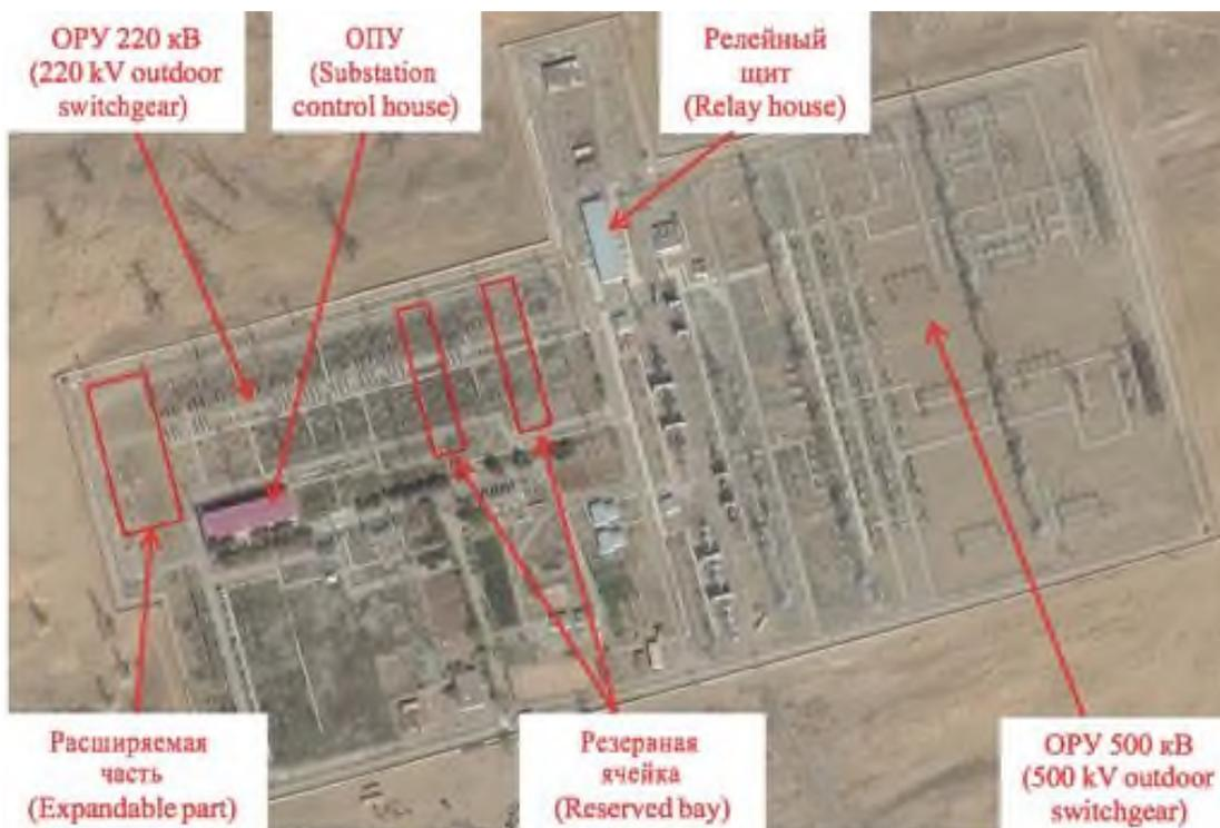
**Рисунок 10: Схема подстанции Сурхан**
